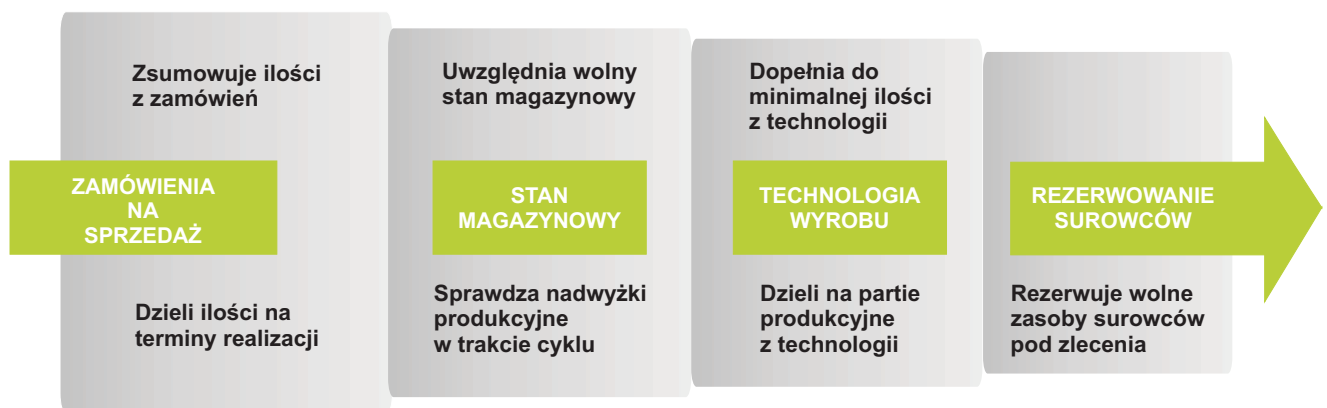
Algorytm generowania zleceń produkcyjnych na podstawie zamówień od klienta
